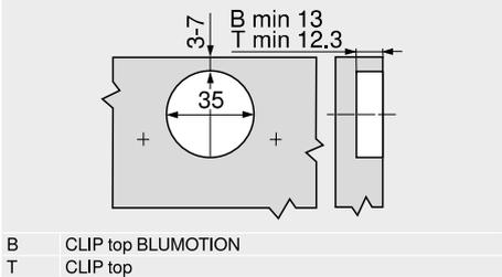
Sistema di montaggio INSERTA
