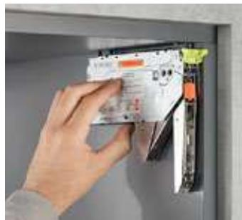
È possibile scegliere tra due tipi di base forza simmetrici e due modalità di montaggio. Una variante prevede la base forza con il rilevamento della posizione integrato senza preforatura, per un montaggio semplice e immediato. In alternativa, la base forza con viti EURO premontate. Per quest'ultima, sono necessarie quattro preforature nello schema di suddivisione a 32
