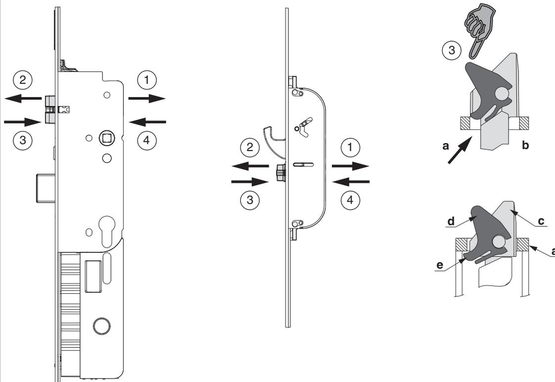
**1)** Allentare completamente la vite e spingere lo scrocco in avanti con il cacciavite!
