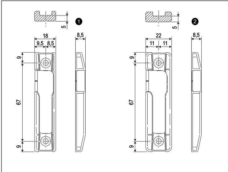
Aria 12 mm, interasse 9 e 13 mm, sede 18 e 24 mm
