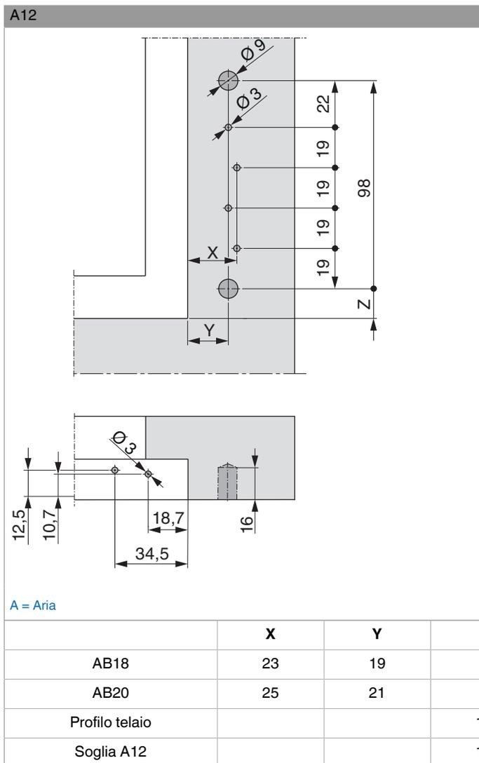
**Schema per foratura/fresatura/avvitamento**
