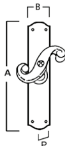
Cremonese a incasso Recessed cremone bolt Martellina con placca T handle with plate
